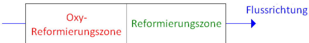
Abbildung 5.1: Axiale Darstellung der Zonen im Katalysator
