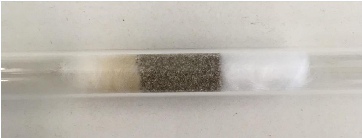
Abbildung 3.3: Darstellung des Pulverkatalysatorbetts. 300 mg Katalysator und 700 mg  $\text{SiO}_2$  von Glaswolle in einem Quarzglasrohrreaktor eingebettet.
