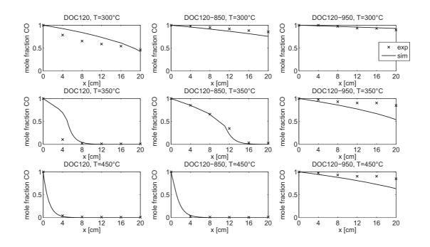
**Abbildung 8:** Axiale Profile der CO Oxidation für DOC120, DOC120-850 und DOC120-950 bei T=300, 350 und 450°C mit 15000 ppm CO im Feed. Der Molanteil ist in der Darstellung auf den Feedwert normiert. Als Referenzkatalysator wurde der DOC120-850 an die Experimente angepasst. Für den DOC120 und den DOC120-950 wurde lediglich die Geschwindigkeitskonstante mit  $\rm F_{cat/geo}$  skaliert.
