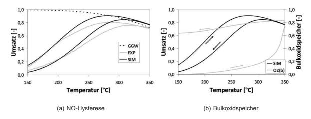
Abbildung 14: Mikrokinetisches Modell zur Platinoxidbildung
