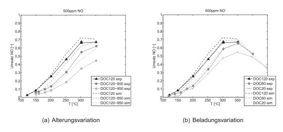
Abbildung 9: NO Oxidation auf mager vorbehandeltem Katalysator
