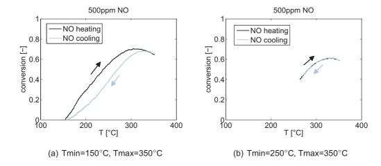
**Abbildung 12:** NO-Umsatz bei einer linear ansteigenden und anschließend abfallenden Temperaturrampe (+/-5 K/min) bei 150°C Starttemperatur (a) und 250°C Starttemperatur (b).
