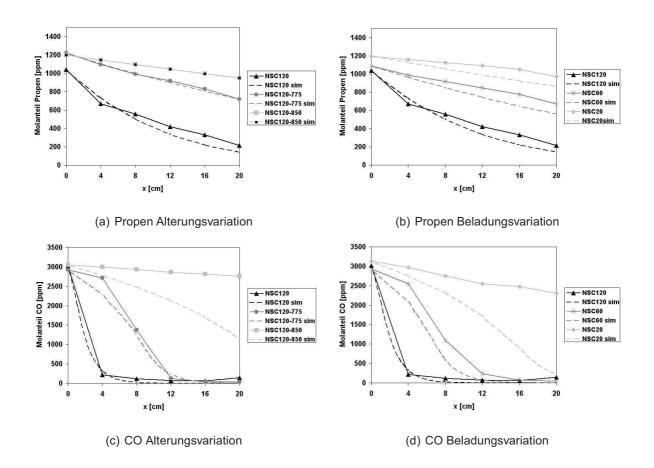
**Abbildung 15:** Vergleich von Experiment und Simulation nach  $F_{\rm cat/geo}$ -Korrelation für die NSCs anhand der axialen Profile für die CO Oxidation (3000ppm CO, 12%  ${\rm O_2}$ , T=180°C) und die Propen Oxidation (1200ppm  ${\rm C_3H_6}$ , 12%  ${\rm O_2}$ , T=180°C).
