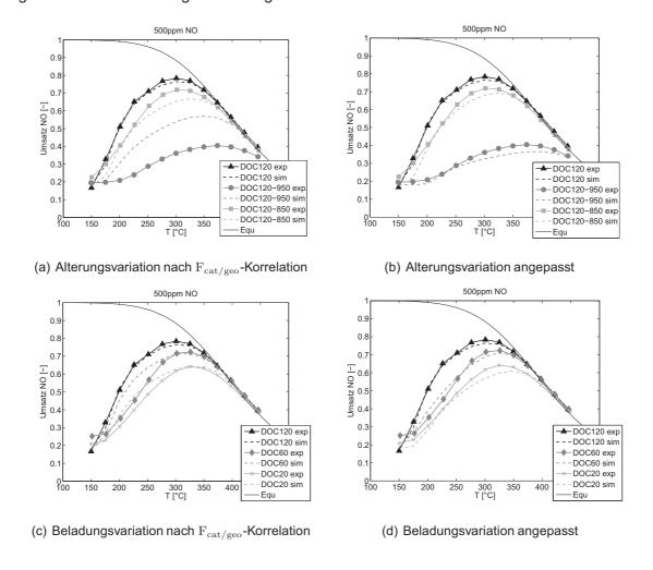
Abbildung 10: NO Oxidation auf reduziertem Katalysator
