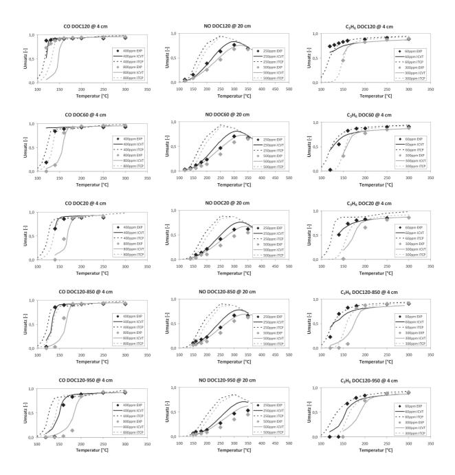
Abbildung 16: DOC: Umsätze der Oxidationsreaktionen von CO, NO und Propen
