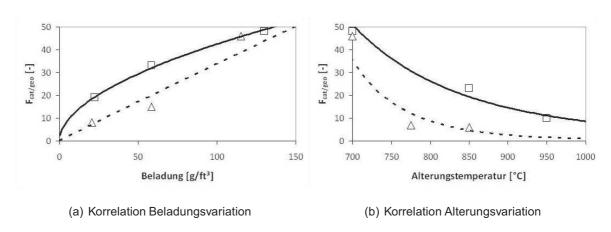
**Abbildung 3:** Korrelation von Beladungs- und Alterungsvariation mit  $F_{cat/geo}$ ; DOC:  $\Box$ , NSC:  $\Delta$ ; Potenzfunktion: DOC — und NSC - - -
